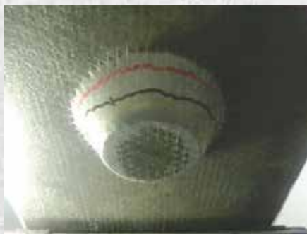
押抜き試験状況 (V1仕様)
