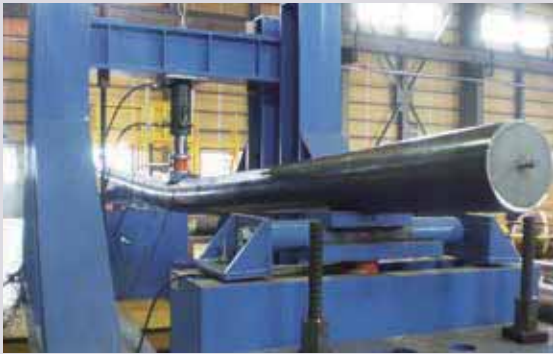
静的載荷実験の状況
