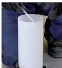
汚れ防止材をカートリッジ内にセットする。
