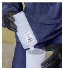
粉体①を全量投入する。 (遅延剤使用時は、粉体①投入後に、遅延剤投入)
