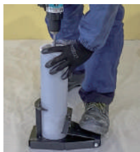
回転具に専用攪拌棒を取付け、混合を行う。
