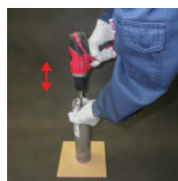
回転具に専用攪拌棒を取り付け、混合を行う。
