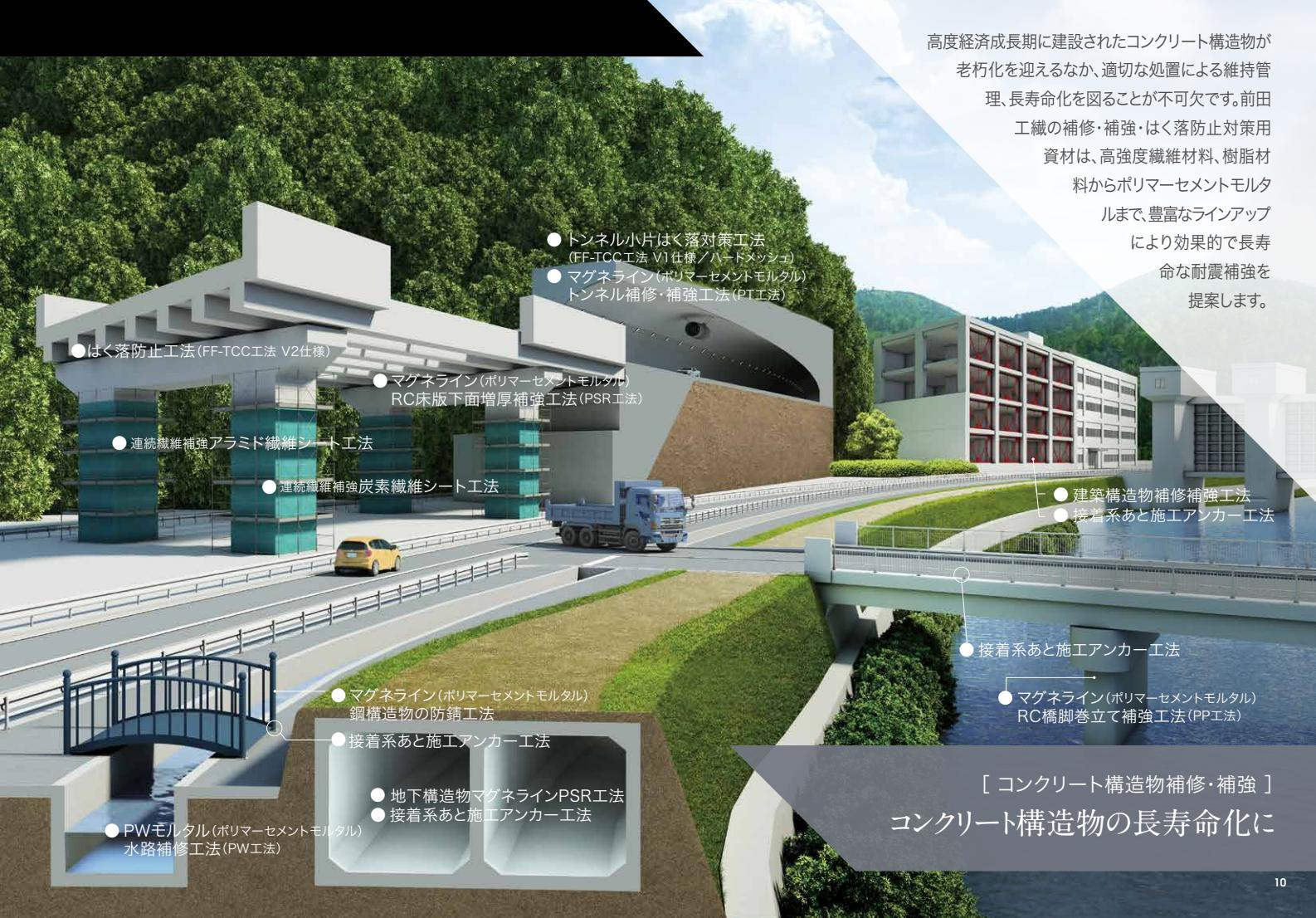
高度経済成長期に建設されたコンクリート構造物が老朽化を迎えるなか、適切な処置による維持管理、長寿命化を図ることが不可欠です。前田工織の補修・補強・はく落防止対策用資材は、高強度繊維材料、樹脂材料からポリマーセメントモルタルまで、豊富なラインアップにより効果的に長寿命な耐震補強を提案します。
