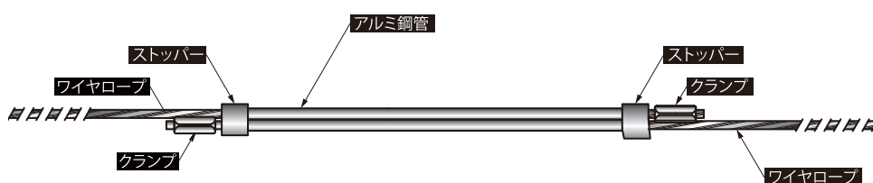
ワイヤロープに張力が発生し、アルミ鋼管が変形
