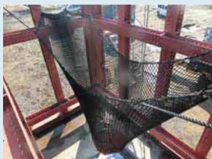
重錘落下実験（自由落下）50kJ
