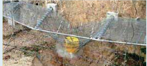
支柱間隔 10m での実物実験
