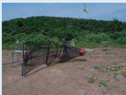
衝撃载荷実験（振り子式）100kJ
