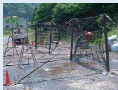
衝撃载荷実験（振り子式）150kJ
