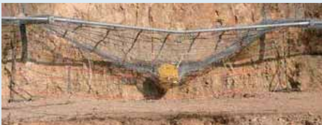
国内最大級である 1000kJ の実物実験
