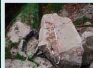
宮城県大崎市鳴子/I型/推定落石エネルギー:約2500kJ/事故後の対応:全撤去後再構築をおこないました
