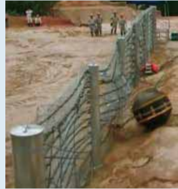
衝突後ループ構造により柵高減少を抑え支柱の変位もわずか
