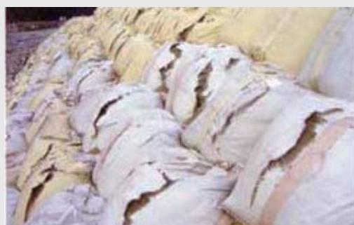
大型土のうの破損事例…平成 16 年 7 月 17 日～18 日福井豪雨の被災箇所
