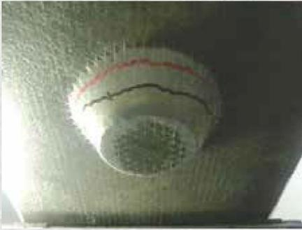
押抜き試験状況 (V1仕様)
