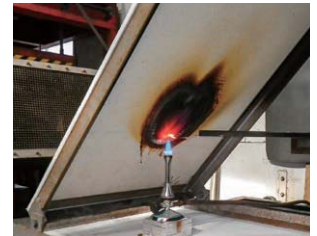
延焼性試験状況
