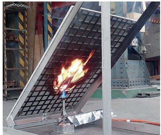
延焼性試験状況 (HM-C22) NEXCOはく落対策工の延焼性・自己消火性規定値を満足しています
