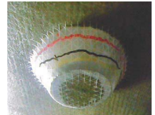
押抜き試験状況
