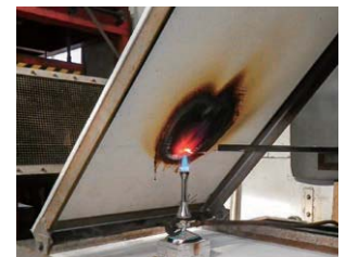
延焼性試験状況
