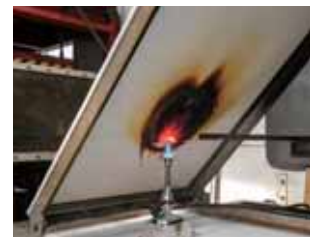
延焼性試験状況
