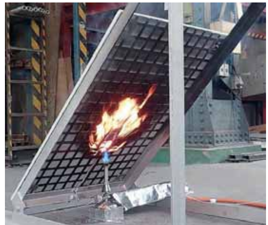
延焼性試験状況( HM-C22 ) NEXCO はく落対策工の延焼性・自己消火性規定値を満足しています
