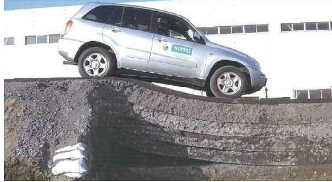
図-1 沈下時の車両の通行状況
