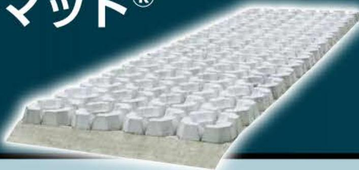
シビックマットは、ポリエステル製不織布のフィルターシートに、コンクリート製ブロックを配置・固定した河川護岸用ブロックマットです。のり面に敷設することにより斜面の安定を図り、美しい幾何学模様の護岸を構築。覆土し緑化することも可能です。また、用途に応じて防草・防災タイプも取り揃えております。
