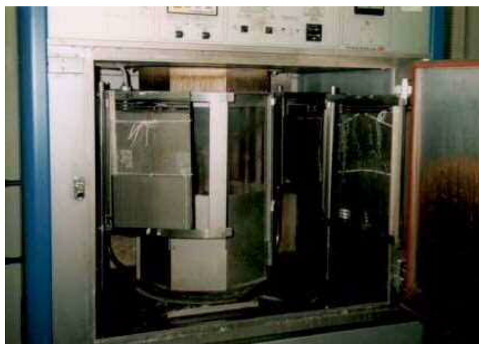
サンシャインカーボンアーク灯式耐候性試験
