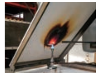
延焼性試験状況
