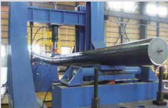
静的載荷実験の状況
