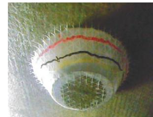
押抜き試験状況
