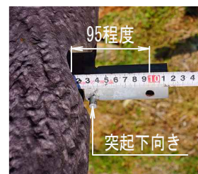
【参考3】 特殊金具ねじ込み距離 金具の突起が下向きになるよう調整
