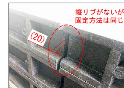
【写真4b】継ぎ目部拡大（カット品）
