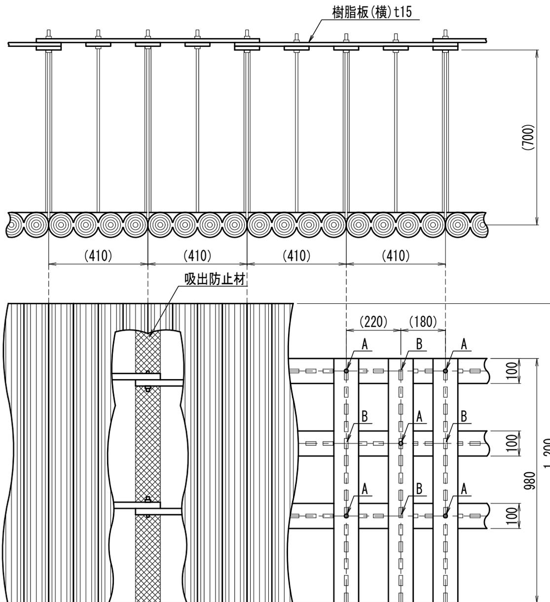
※ A: Lボルト・B: M10ボルト×70L を示す。
